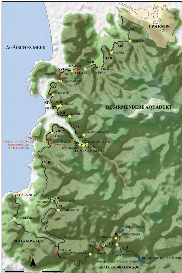
Ephesos, Değirmendere-Aquädukt. Übersichtskarte des Aquädukts. Blau = Quelle, rot = Tunnel, gelb = Brücke, einbogig; gelb mit braunem Punkt = mehrbogige Brücke, gelb mit orangem Punkt = Sonderbrücke: Mercankuyu = zweigeschossig, Bahçecikboğaz = Siphonbrücke (Grafik C. Kurtze)
