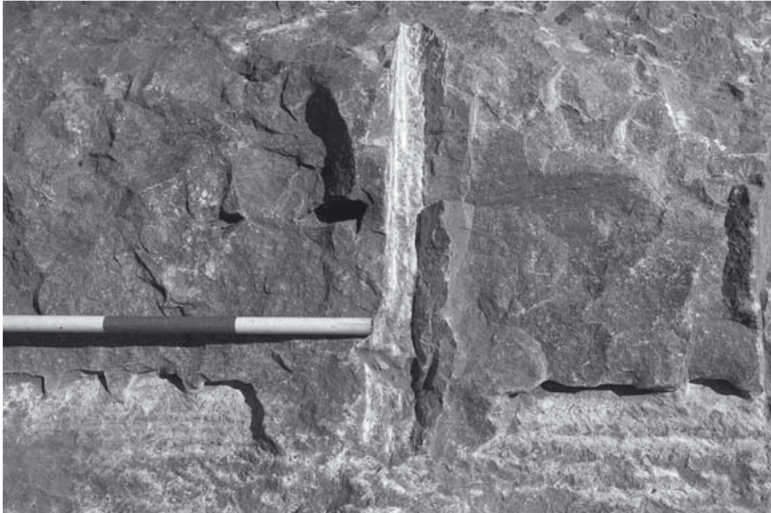
Taf. 32, 1: Werkspuren und Kanäle der Spaltkeile, nördlicher Steg der Abbauzone (2001)
