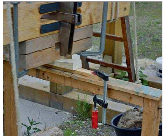
Abb. 19 Funktionsmodell der Steinsäge von Ephesos. Versuchsaufbau mit auf Böcken montierten Keilen (hell), die einen Aushub des Sägerahmens an den Umkehrpunkten seiner Pendelbewegung verursachen.
