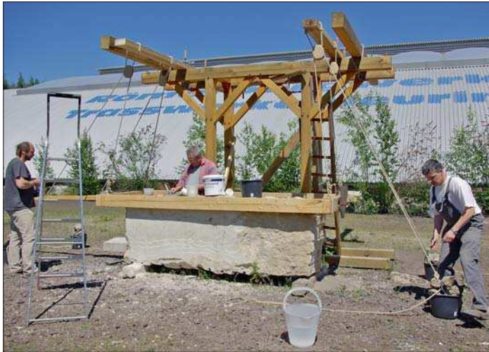
Abb. 18 Funktionsmodell der Steinsäge von Ephesos. Schubstange, Sägerahmen und Galgenkonstruktion zur Aufhängung. Versuchsaufbau mit nach innen versetzten Querbalken, auf den Boden außerhalb des Rahmens gestellten Kontergewichten bei straff gespannten Pendelseilen.
